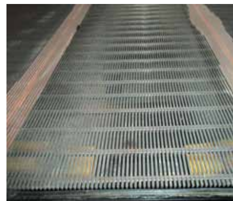
Рис. 10. Шпальтовая ситовая поверхность нижней деки 2 мм
