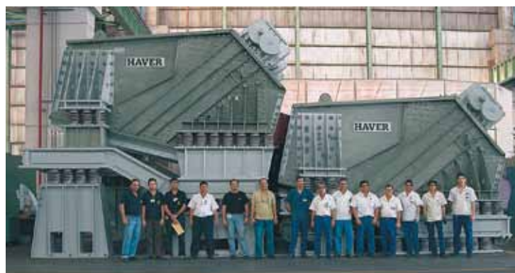
Рис. 2. Линейный инерционный грохот NIAGARA тяжелого типа
