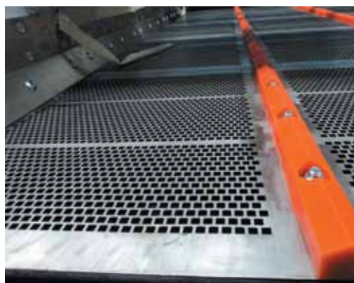
Рис. 9. Перфорация 13x13 мм верхней деки
