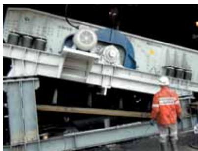
Рис. 6. Гирационный грохот перед отсадкой по классу 0-100мм
