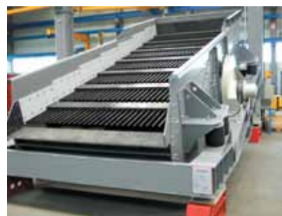
Рис. 7. Пример ситовой поверхности. Пальчиковые колосники. Классификация с очисткой.
