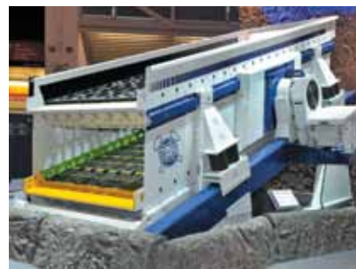
Рис. 5. Гирационный грохот для контрольной классификации
