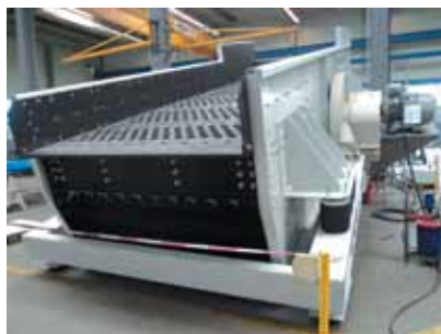
Рис. 4. Гирационный разгрузочный грохот перед валково-зубчатой дробилкой по классу рядового угля 0-80мм
